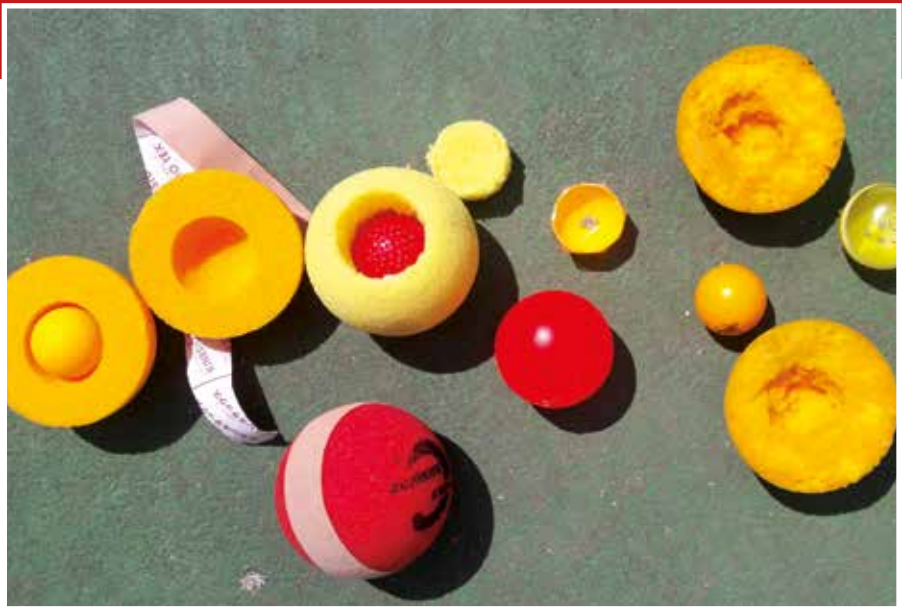
Abbildung 1: Entwicklung des Blindentennisballs. Mittig sieht man einen ersten Prototypen aus Plastik mit zu wenig Sprungkraft sowie links daneben den aktuellen Schaumstoffball, gefüllt mit einem rasselnden Golfball
